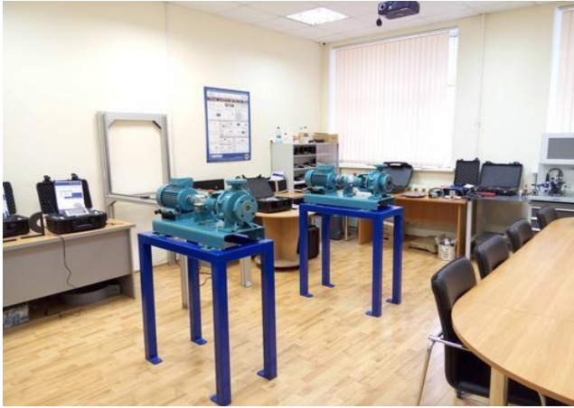
Класс с макетами насосных агрегатов для практических занятий по центровке
